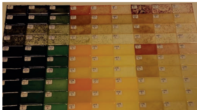
Resinas de polímero biodegradable con nanopigmentos procedentes de colorantes naturales: clorofila, betanina (remolacha) y betacaroteno.
