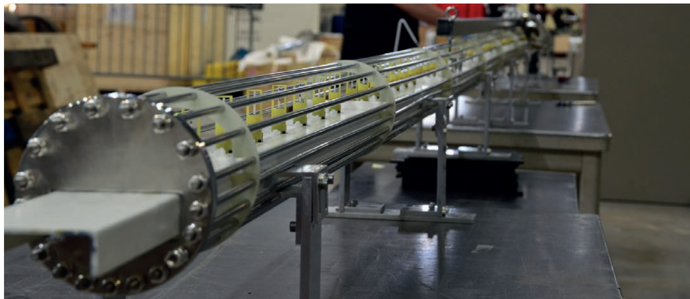
Detalle de la instalación del sistema de medición de temperatura de ProtoDUNE en el CERN. Autor: IFIC.
