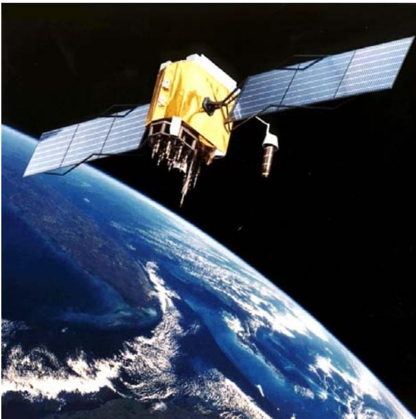
Se desplazan en órbita a una distancia de al menos 150 Km. de la Tierra, ya que de otro modo se quemarían rápidamente en la atmósfera. Su órbita alrededor de nuestro planeta tiene forma circular o elíptica, y unos pequeños motores a bordo, garantizan la escrupulosa precisión de su trayectoria.
